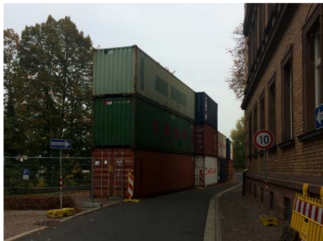
Abbildung 5: Splitterschutz aus Seecontainern
