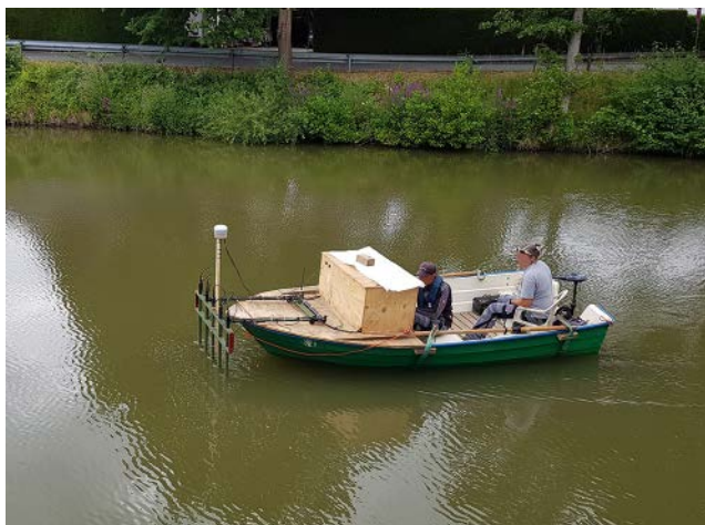
Abbildung 9: Abschließende Kontrollmessung mittels 5-facher Sonde
