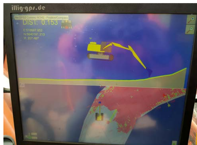
Abbildung 3: Bildschirmansicht auf dem Bagger mit Darstellung des Räumfortschritts
