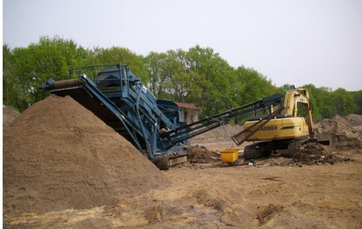
**Bodensiebanlage mit Magnetabscheider**
