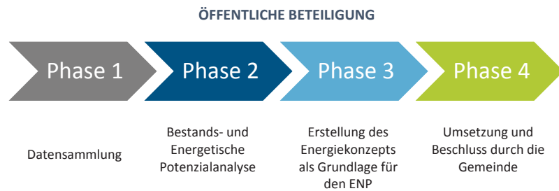
Abb. 4.8.1 Prozessablauf zur Umsetzung eines Energienutzungsplans | Quelle: Dittmer
